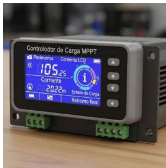
Figura 9. Controlador de carga MPPT con display digital
