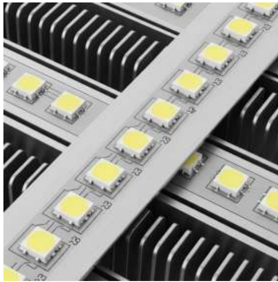
Figura 12. Tiras LED de alta eficiencia con chips LED individuales
