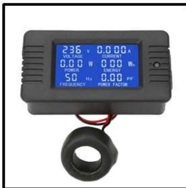
Figura 4.14 Medidor de energía PZEM-022 AC.
