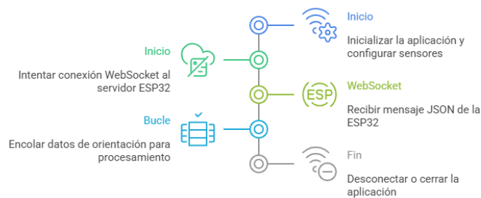
Figura 4.11 Diagrama de flujo de conexión y recepción de datos por WebSocket.
