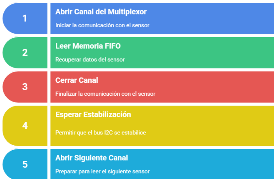
Figura 4.3 Proceso de lectura de los sensores
