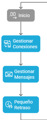
Figura 4.10 Diagrama de flujo del funcionamiento del servidor WebSocket.
