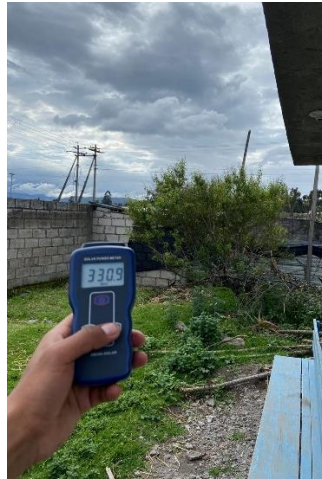
Figura 4.12. Medición de la radiación solar con el piranómetro
