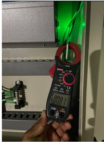
Figura 5.35. Medición de la corriente consumida en AC
