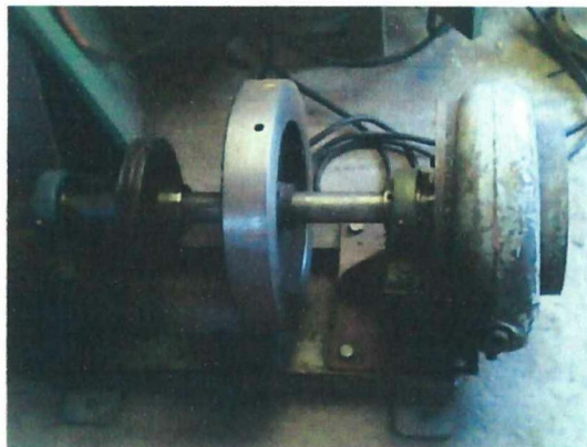
Vista posterior de la turbina, eje, contrapeso
