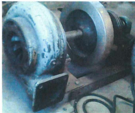
Entrada del agua en la turbina tipo Mini Francis
