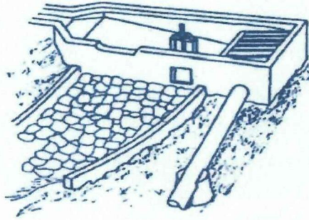
Figura 1. 25 CÁMARA DE CARGA Y/O DESARENADOR
