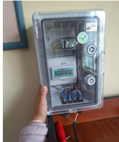
Instalación del equipo emisor de datos en el router del usuario residencial
