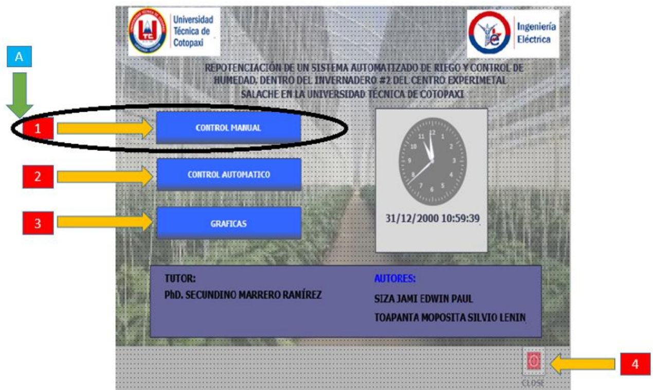
Imagen 2: Pantalla Principal HMI seleccionando 1 CONTROL MANUAL
