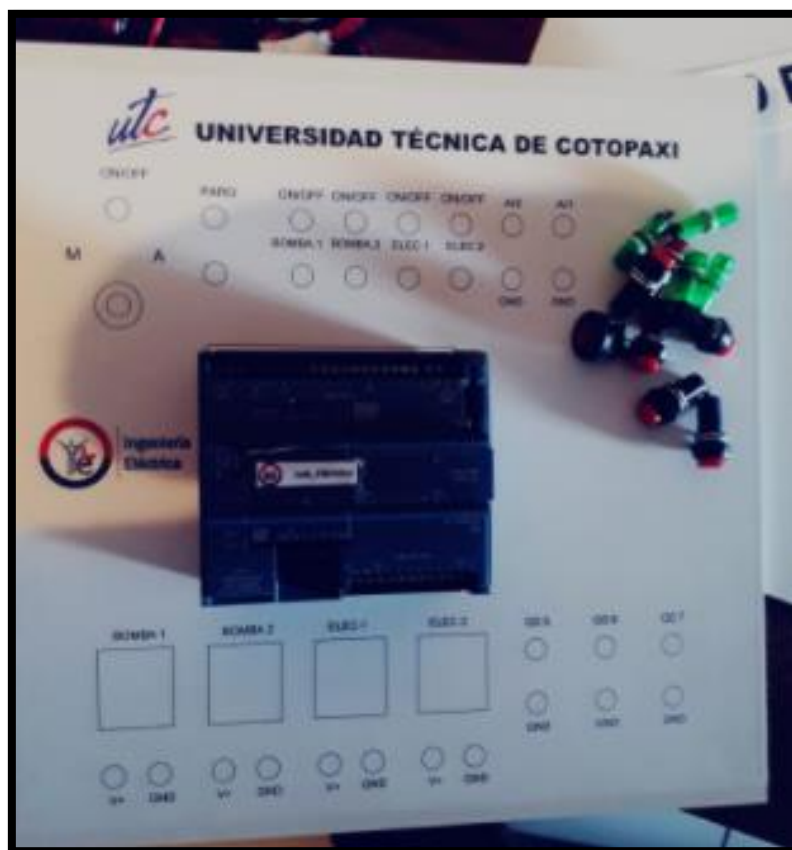
Anexo 1.4 Diseño y ubicación del PLC en el tablero de control manual.
