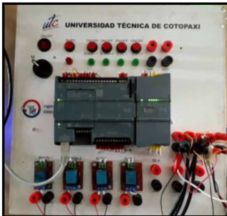
Anexo 1.8 Conexión de todos los dispositivos para la prueba de funcionamiento.
