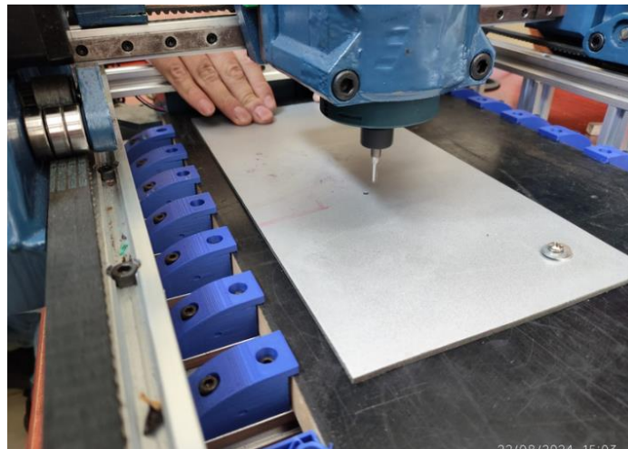
Anexo 25 26 y 27. Pruebas en aluminio de 3mm
