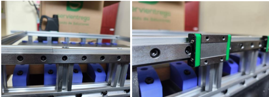
Figura 4. Instalación de Riel fija estructural
