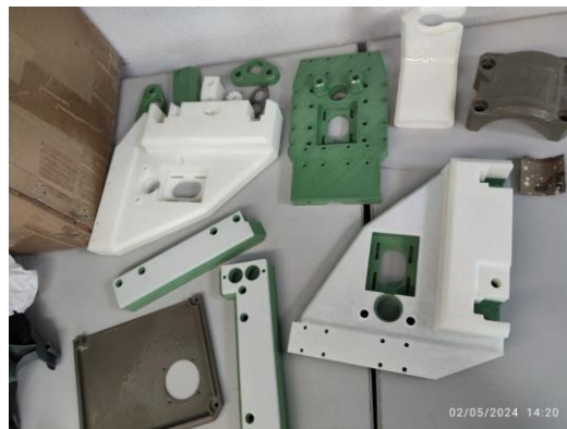
Figura 5. 6. Piezas impresas recubiertas con Resina Epóxica
