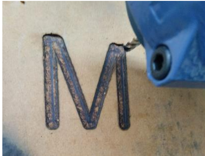
Anexo 25 26 y 27. Pruebas en aluminio de 3mm
