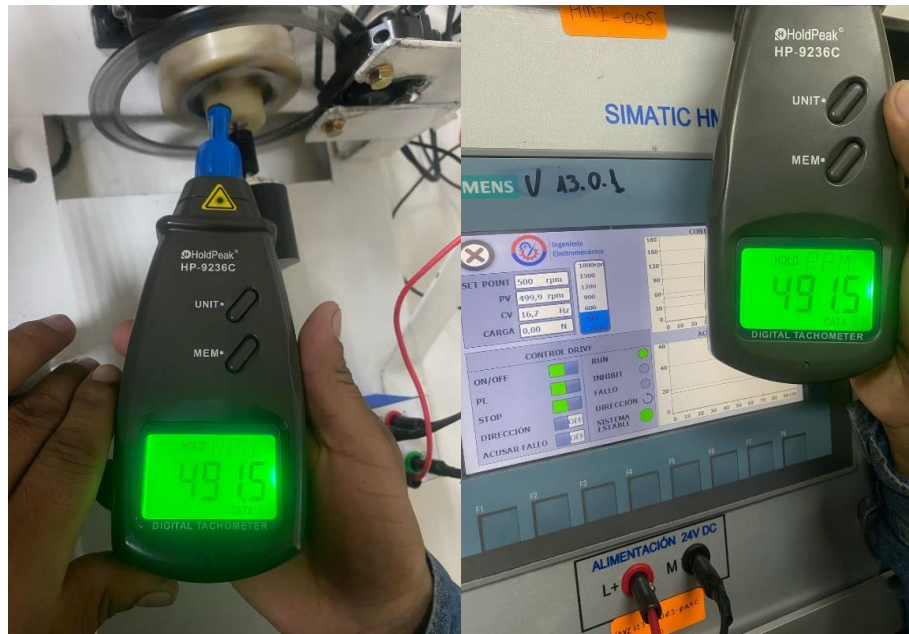
Figura 4.30 Validación de velocidad con el tacómetro
