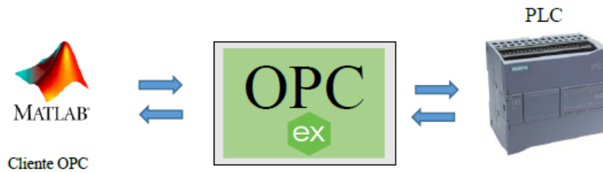
Figura 3.12. Estructura de comunicación OPC server.[3]
