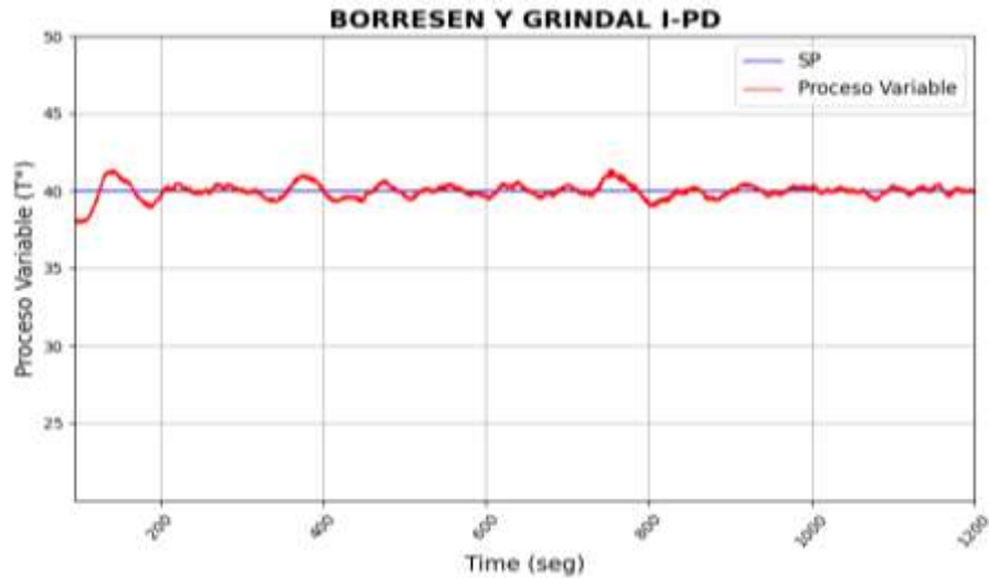
Figura 4.33 Proceso real del I-PD, ajustado con parámetros de Borresen and Grindal
