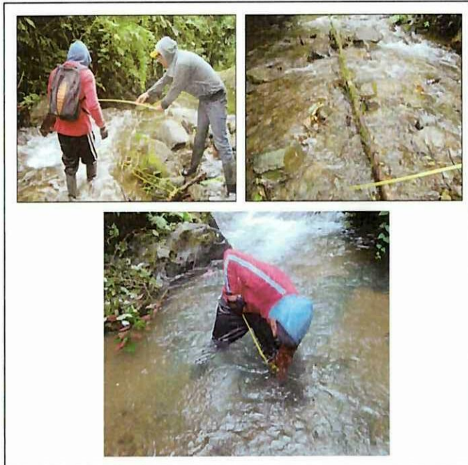
FIGURA N°3.1. MEDICIÓN DEL CAUDAL, AREA-VELOCIDAD.
