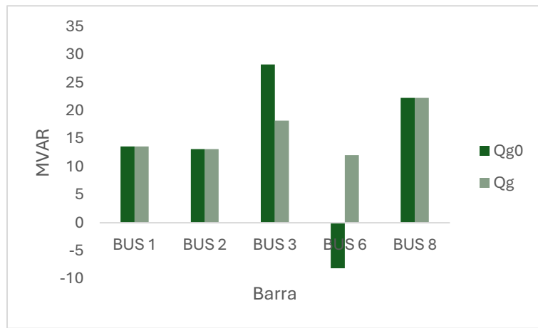
Figura 10. Generación de potencia reactiva.
