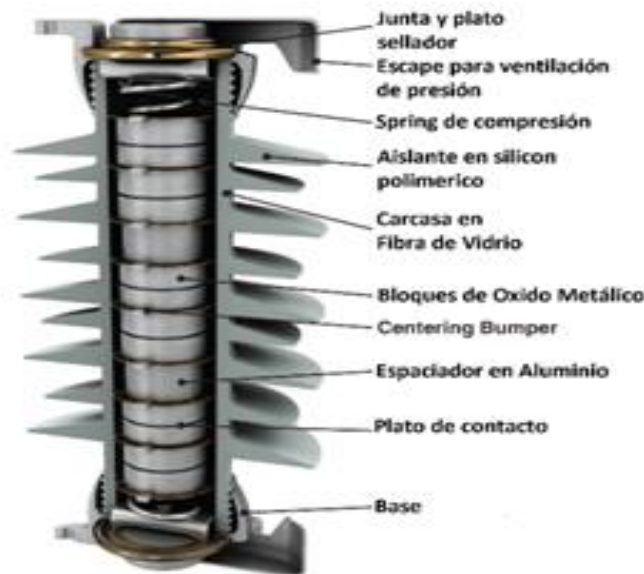
Figura 10. Esquema de un pararrayo para media tención
