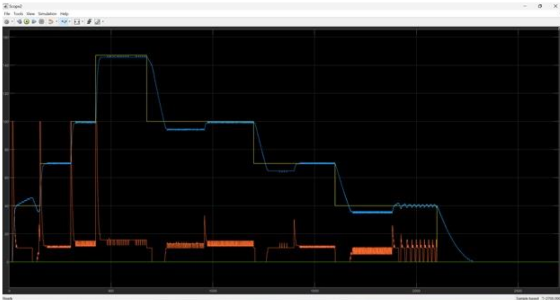
Figura 5.2 Comportamiento de control Fuzzy para un proceso virtual de nivel
