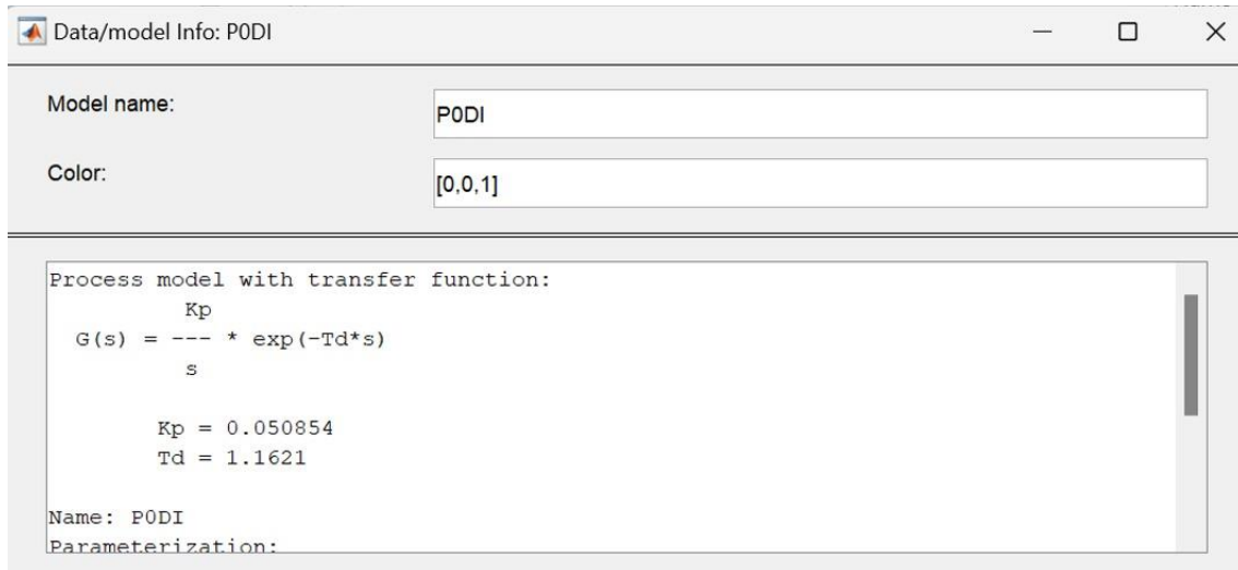
Figura 4.8 Valores de la función de transferencia.
