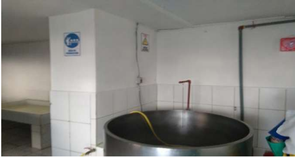
Fotografía 11: Tanque de enfriamiento o tanque de la leche limpio y desinfectado.
