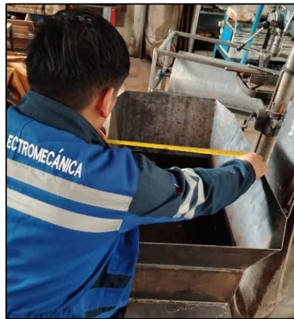
Figura 5.10: Verificación dimensional de la tolva durante el proceso de fabricación.
