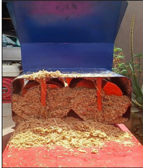
Figura 5.17: Remanente de bagazo de caña en la máquina ensiladora.
