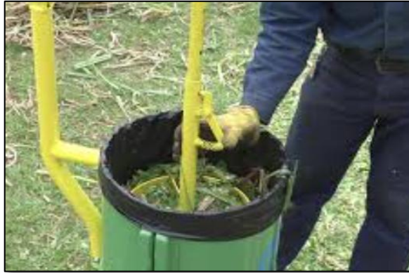
Figura 3.7: Ensiladora compactadora manual [21]
