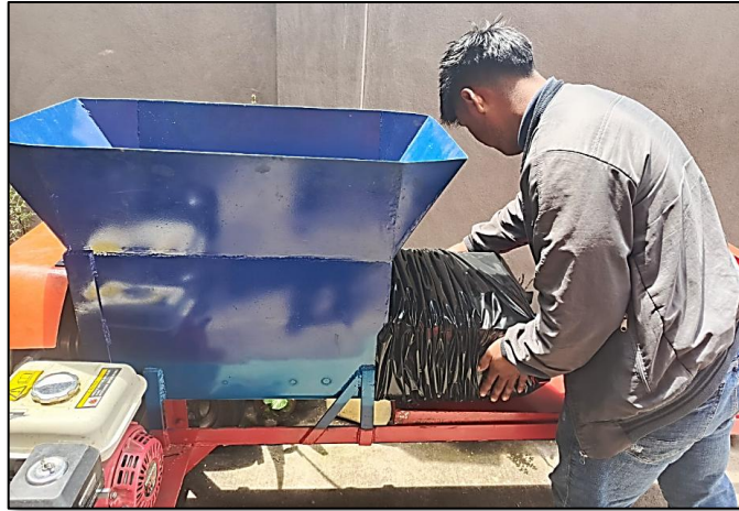
Figura 5.13: Montaje de la funda al conducto de salida de la maquina ensiladora.
