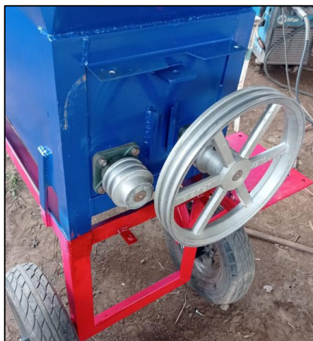
Figura 5.12: Montaje del sistema de transmisión mediante poleas y chumaceras.
