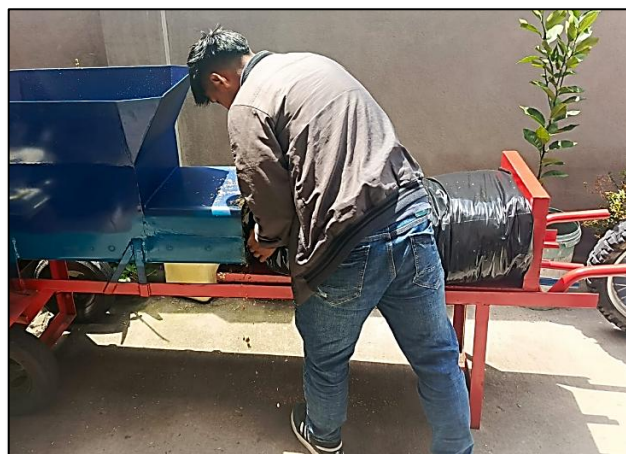
Figura 5.16: Extracción de la funda al finalizar el proceso de ensilaje y compactación.
