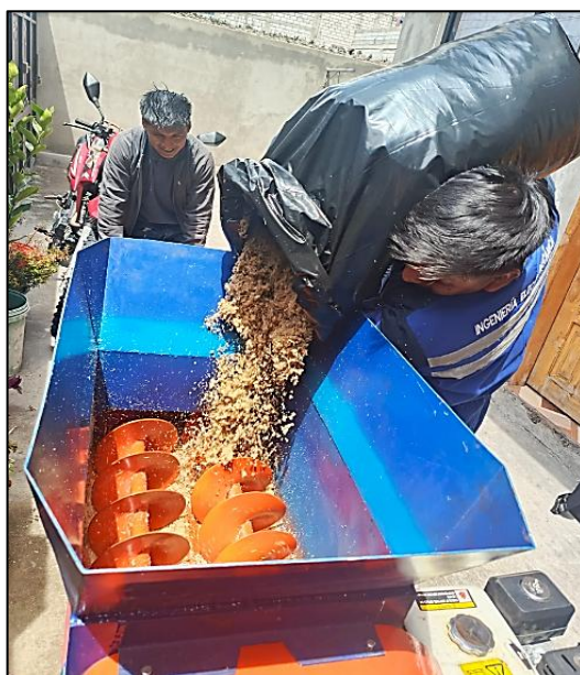
Figura 5.14: Alimentación del bagazo de caña en la tolva.
