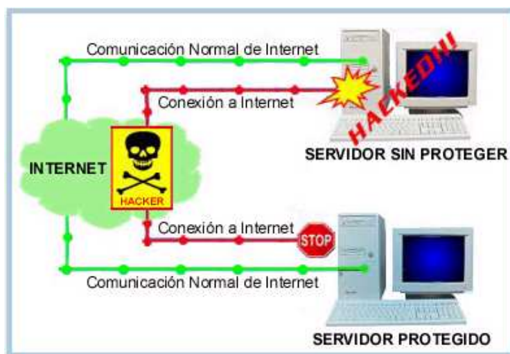
Figura 1.4: Forma de funcionamiento de un Firewall
