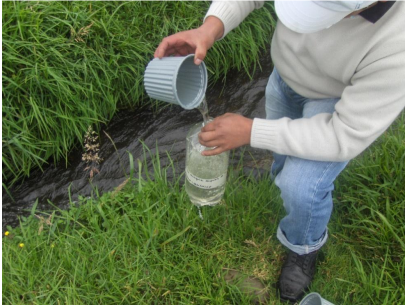
Foto N° 14 Colocación de la muestra de agua en el recipiente.
