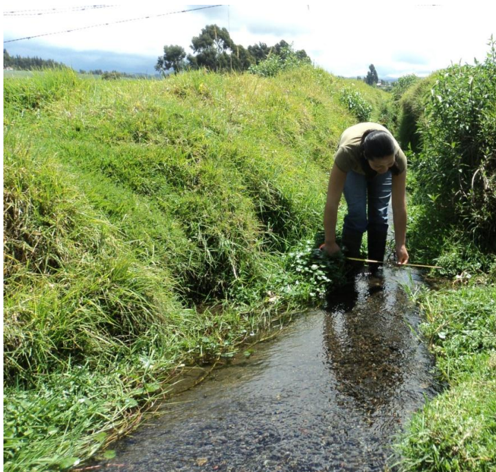
Foto N° 22 Medición del ancho de la acequia para el cálculo del caudal
