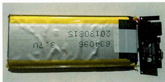
Figura 5. 12. Batería Lipo 3200 m.A
