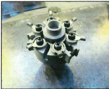
FIGURA N° 1.7 CAMBIADOR DE DERIVACIONES MONOFÁSICO EXTERNO 5 PASOS
