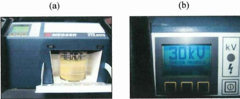
FUENTE: EEARCN S.A., medidor de la rigidez dieléctrica
