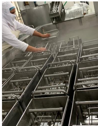
Figura 5.16. Transporte de los moldes hacia la piscina de congelamiento
