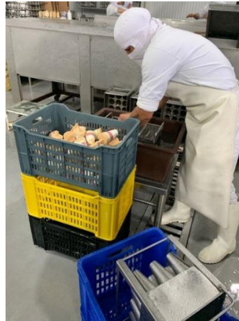
Figura 5.19. Desmolde de helados
