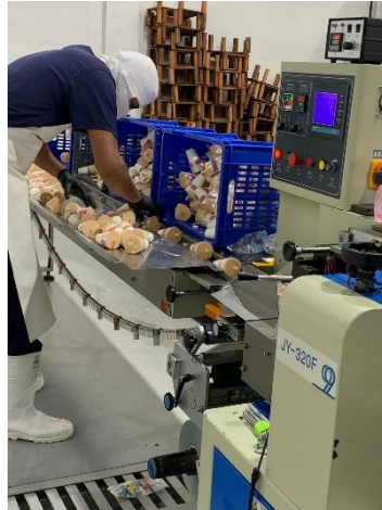
Figura 5.23. Colocar el helado en la banda transportadora
