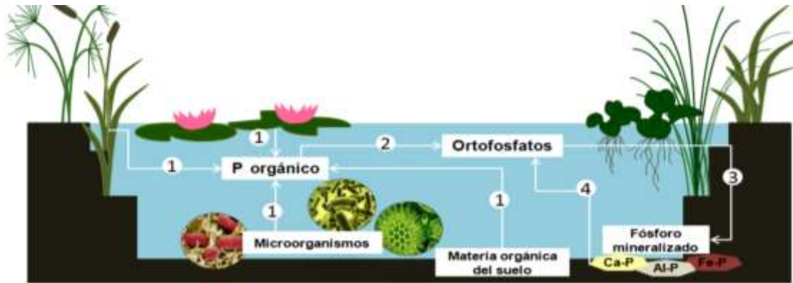
Figura 2. Ciclo del fósforo: 1 Descomposición de materia orgánica; 2 Mineralización; 3 Fijación; 4 Liberación-Reducción. Dibujo extraído de Luévano, 2016.
