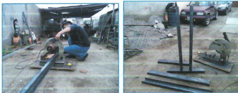
FIGURA 3.24: CORTE DE CANAL U
