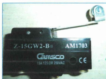
FIGURA 3.20: FINALES DE CARRERA ELÉCTRICOS
