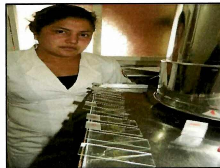
Anexo 18: Colocación del cubreobjetos en el portaobjetos
