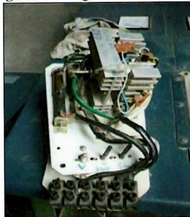
Figura 51 Regulador de Voltaje
