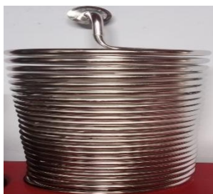
Figura 9. Introducción de agua en un serpentín
