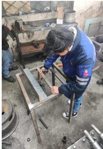
Armado de la base estructural de la roladora.
