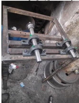
Colocación de chumaceras y ejes, junto al piñón de transmisión.
