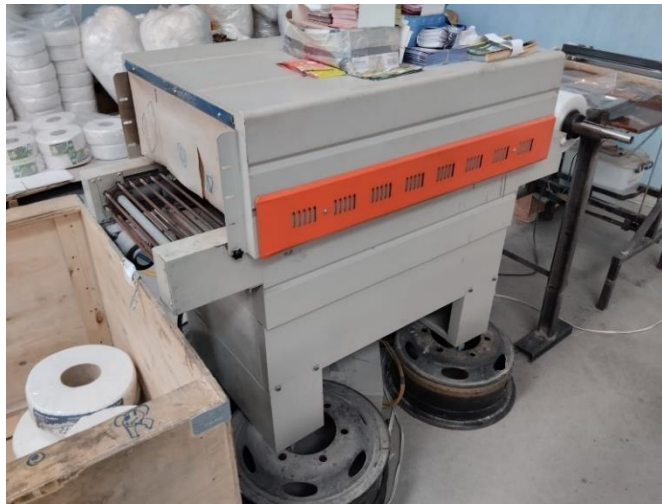
Figura 4.4. Túnel refractario (horno)
