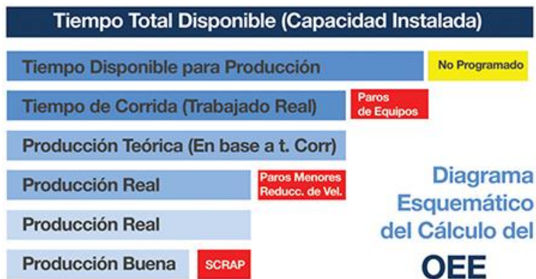
Figura 3.3.4 Diagrama esquemático del cálculo del OEE [12]
