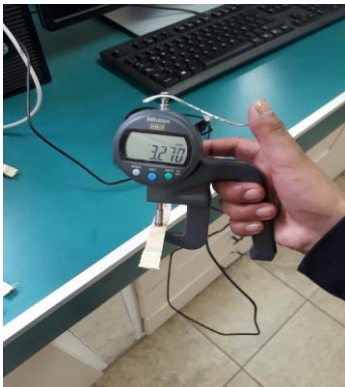
Foto3: Medición de espesores de cada una de las muestras
