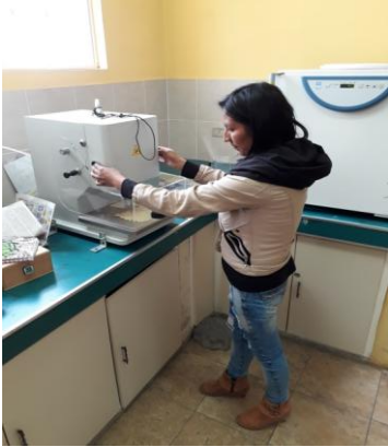
Foto 1: En la máquina troqueladora se obtuvieron láminas
