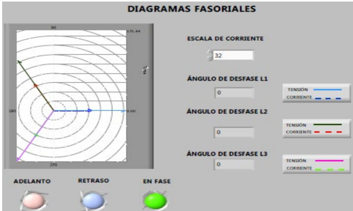
Figura 5.10. Diagrama fasorial de tensión y corriente de la carga resistiva.
