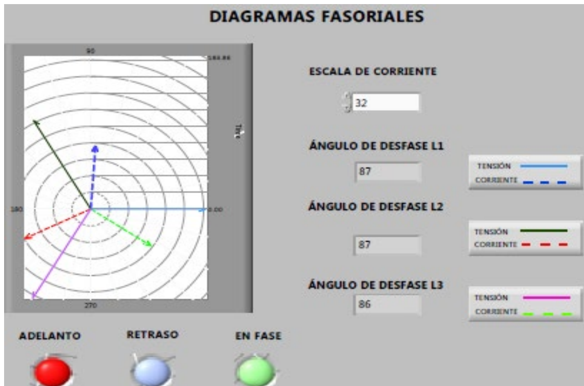
Figura 5.15. Diagrama fasorial de tensión y corriente de la carga capacitiva.
