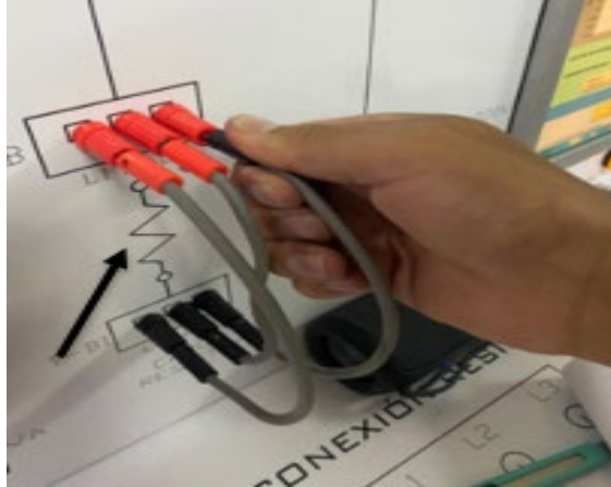
Figura 28. Conexión de los focos
