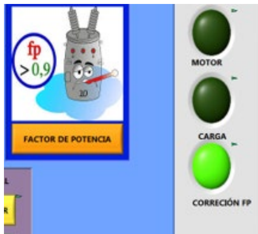
Figura 34. LabView indicativo de encendido de la carga capacitiva
