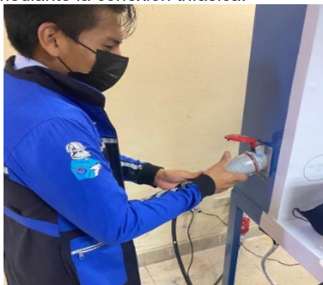
Figura 1. Alimentación trifásica del sistema
