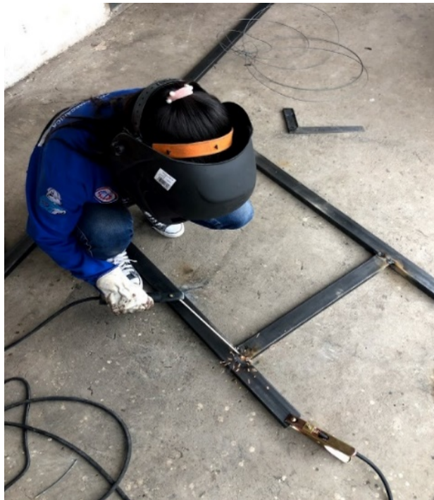
Figura 10. Proceso de soldadura de la mesa
