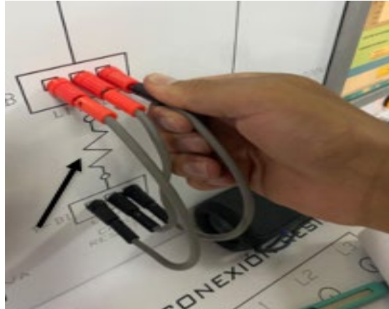
Figura 6. Conexión de los focos
