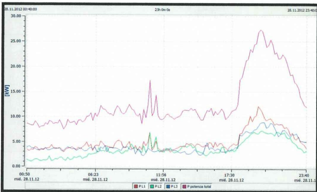
GRAFICO # 22. Curva de carga de un día típico del 2012 en el conjunto habitacional “Campo Alegre”
