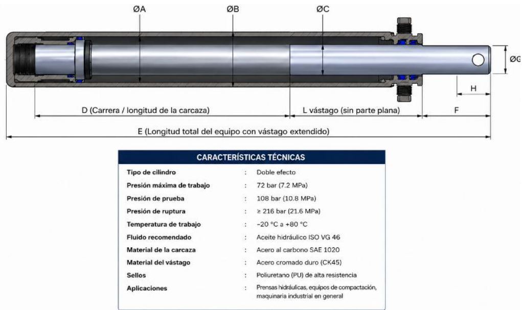
Figura 24. Cilindro hidráulico doble efecto.
