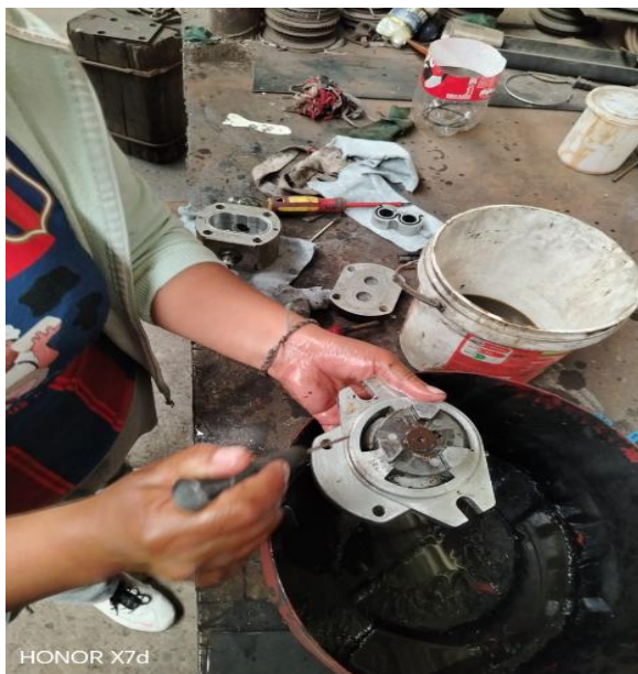
Figura 1: Mantenimiento de la bomba
