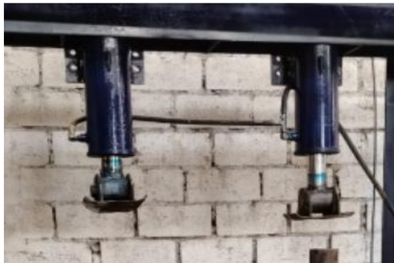
Ilustración 2: Cilindros hidráulicos superiores y conexiones visibles
