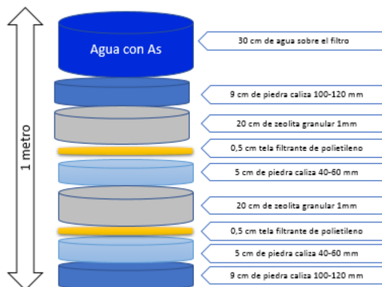
Figura 3. II Distribución del medio filtrante
