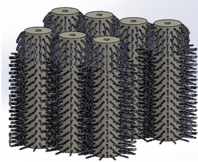
Figura 4.15. Diseño CAD de los cepillos giratorios
