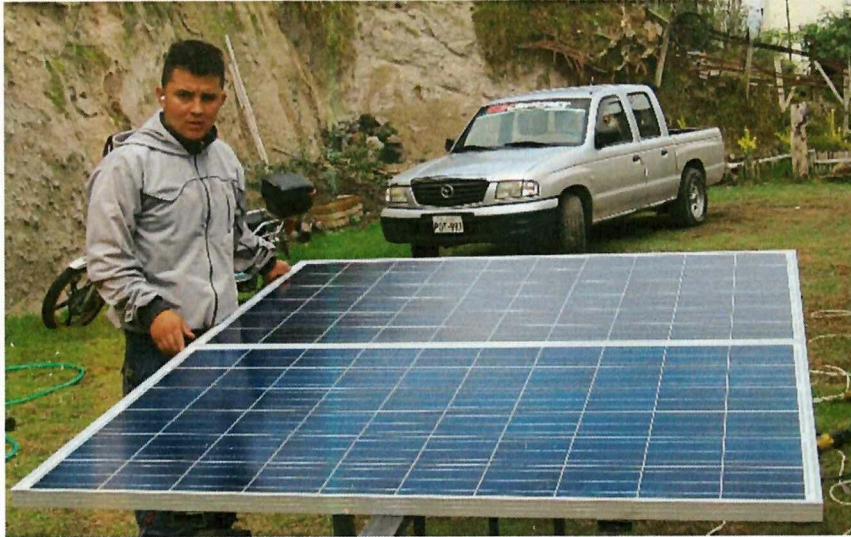
• FIGURA 3. 3 Paneles Policristalinos de 250 W
