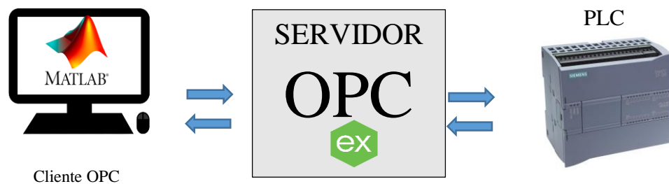
Figura 3. 12 Estructura de comunicación utilizando un OPC server
