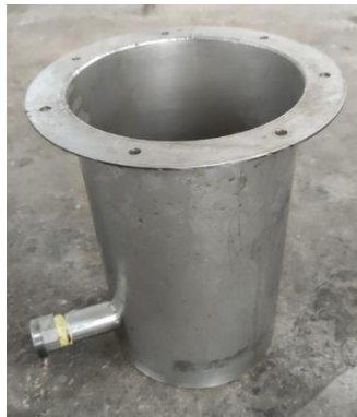
(a) Cuerpo del porta filtro fabricado.
