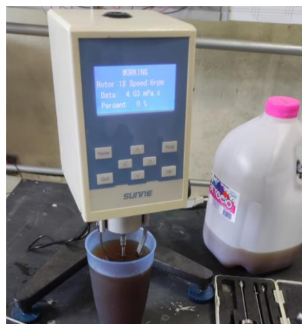
Figura 19. Viscosímetro digital NDJ-8S.
