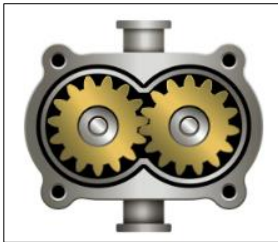
Figura 9. Diseño interno de una bomba de engranajes [24].
