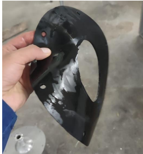
Figura 31. Neopreno de empaque para unir las partes del sistema de filtrado.
