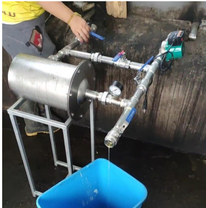
Figura 41. Sistema de prueba del sistema de filtrado con agua.
