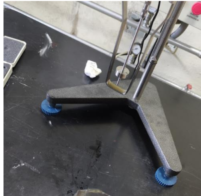
Figura 20. Armado, encendido y nivelación del viscosímetro digital.
