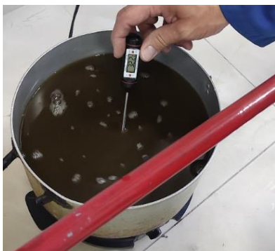
(a) Medición de temperatura del jugo de caña.
