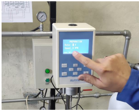
(a) Configuración del viscosímetro para cada rotor.
