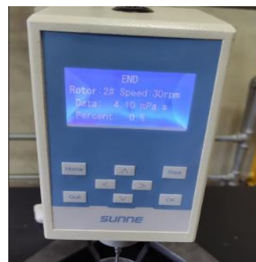
(b) Final del análisis del viscosímetro digital.
