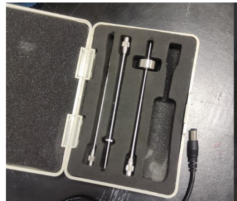
(b) Rotores incorporados en el viscosímetro digital.
