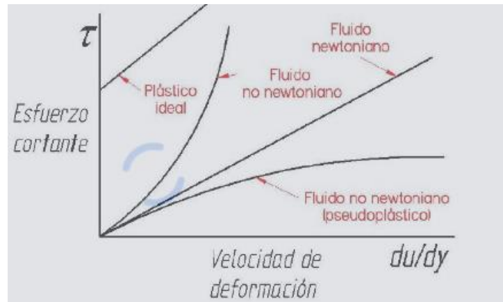
Figura 14. Diferencia entre los distintos tipos de fluidos newtonianos y no newtonianos [35].
