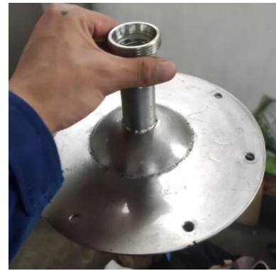
(b) Tapa del porta filtro fabricado.
