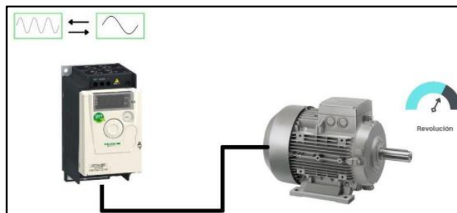
Figura 3. 11 .Variador de frecuencia[12].
