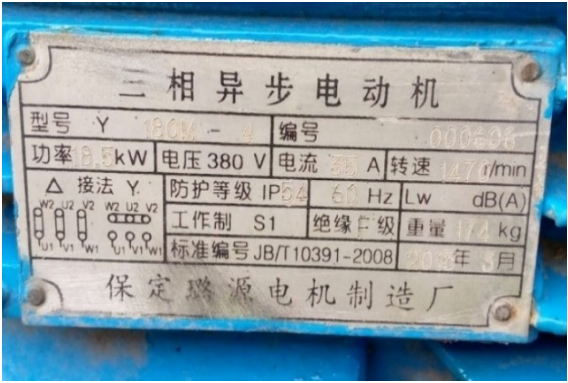
Figura F.6. Placa del motor del extractor (Implementado)
