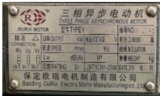
Figura F.9. Placa del motor del extractor
