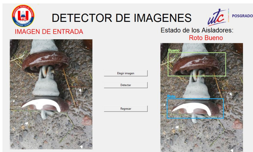
Figura 59. Detección aislador roto.
