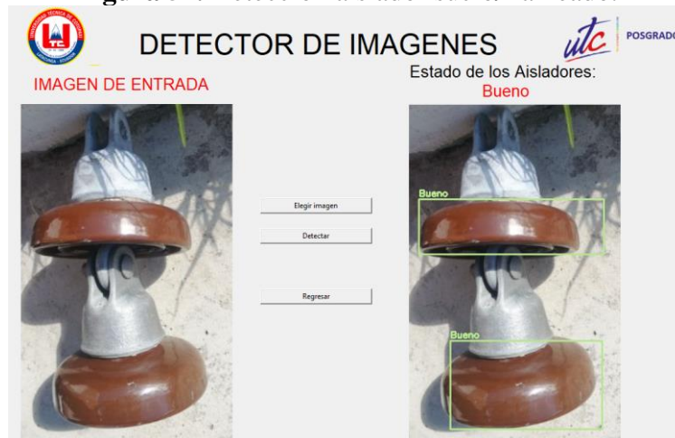
Figura 58. Detección aislador bueno.
