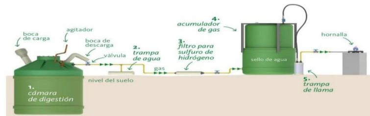
Gráfico 1 Partes referenciales de un biodigestor.
