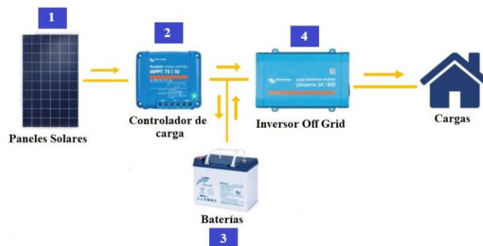
Figura 3.6 Sistema aislado de la red [17]
