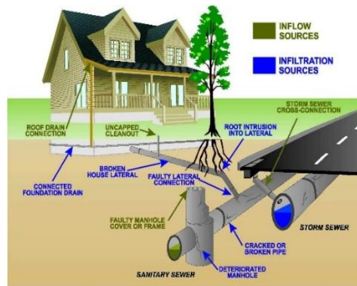
Figura.3. 5 Sistema de drenaje[25]
