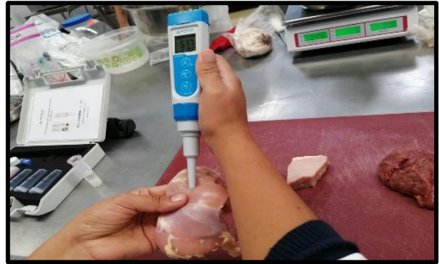
Fotografía 2. Toma de pH de la materia prima con el potenciómetro PH60S
