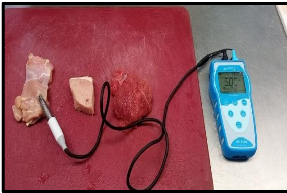
Fotografía 1. Toma de pH de la materia prima con el potenciómetro PH8500
