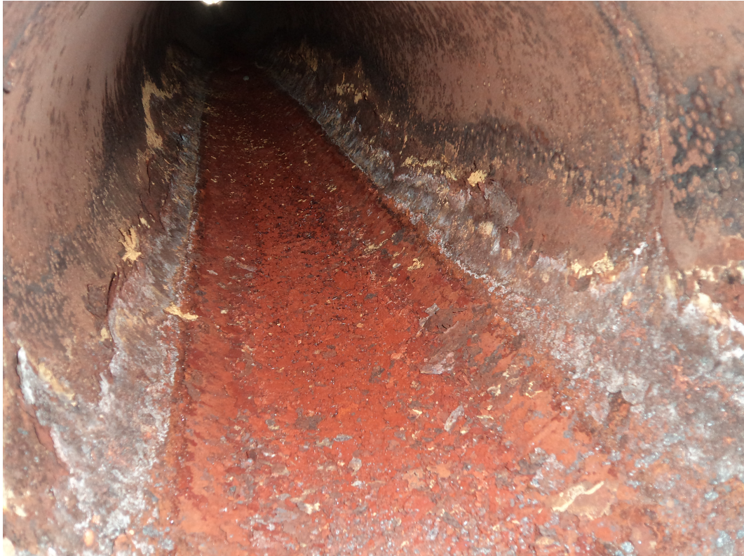
Figura 11. Evidencia física de desgaste por corrosión en tubería.
