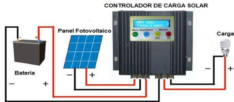
Figura 3.13. Circuito y componentes de un sistema fotovoltaico [16].
